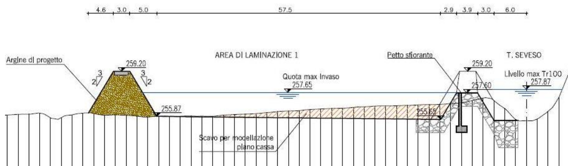
Figura 4.4.4 – Sezione trasversale Area 1: manufatto di sfioro e argine di progetto
